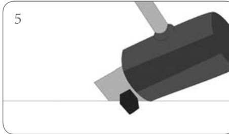
Una vez seco el cemento cola, golpear con una maza de goma lateralmente para romper el calzador.
